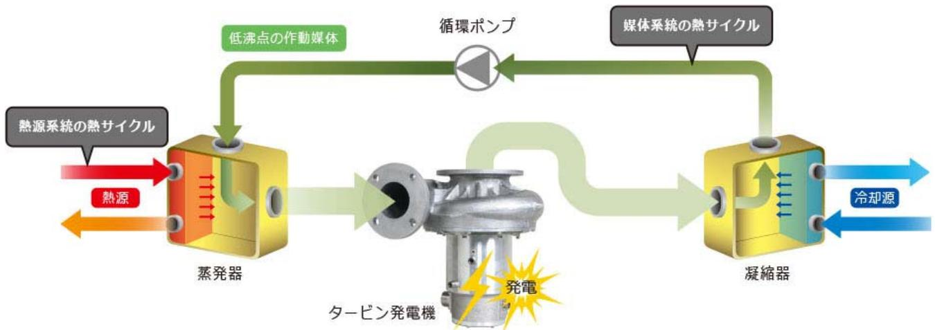
図2 バイナリー発電のしくみ[4]
