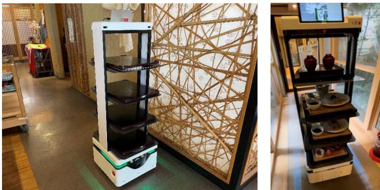
配膳ロボットとして開発した上部システム
